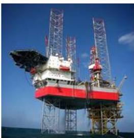
**Plataforma Autoelevável:** Uma balsa com pernas que se estendem até o fundo do mar, elevando a plataforma acima da superfície da água. É usada em perfurações de 5 a 130 metros de profundidade.
